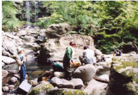
写真2 .調査の様子(吠谷 2001.10.)現場で水質観測,流量測定をし,窒素や磷の分析のための試料を採集します。
